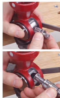
Une simple pression sur un bouton libère l'insert de mesure sans en modifier le réglage. Plus besoin de refaire un réglage quand on change de poudre ou de calibre.
